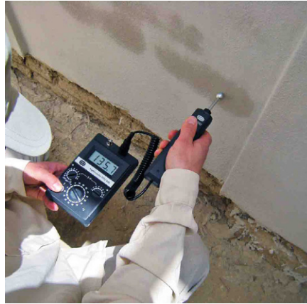
Abb. 2.15: Dunkle Stellen infolge hygroskopisch erhöh- ter Feuchte durch die Verwendung einzelner salzbelasteter Lehm- steine und ihre mess- technische Erfassung (Jahili Fort, Al-Ain, UAE)
