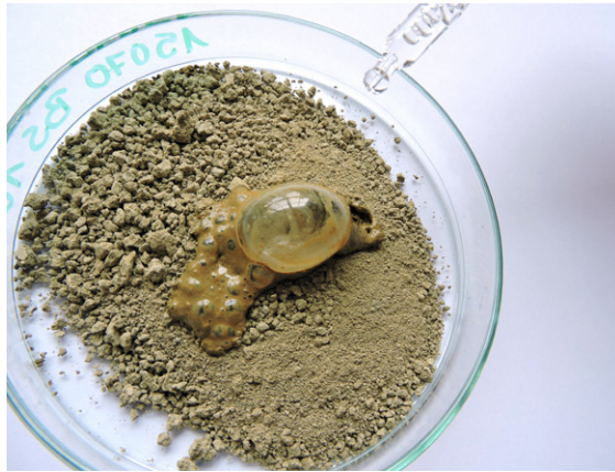
Abb. 2.13: Aufschäumen einer Baulehmprobe mit einem hohen natürlichen Kalkgehalt nach Beträufeln mit 10%iger Salzsäure
